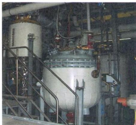
Reattore pilota per sviluppo nuovi lubrificanti
